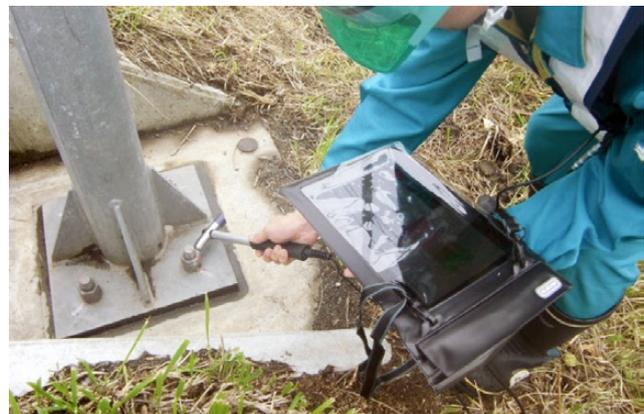
写真2 ナットのゆるみ測定状況
