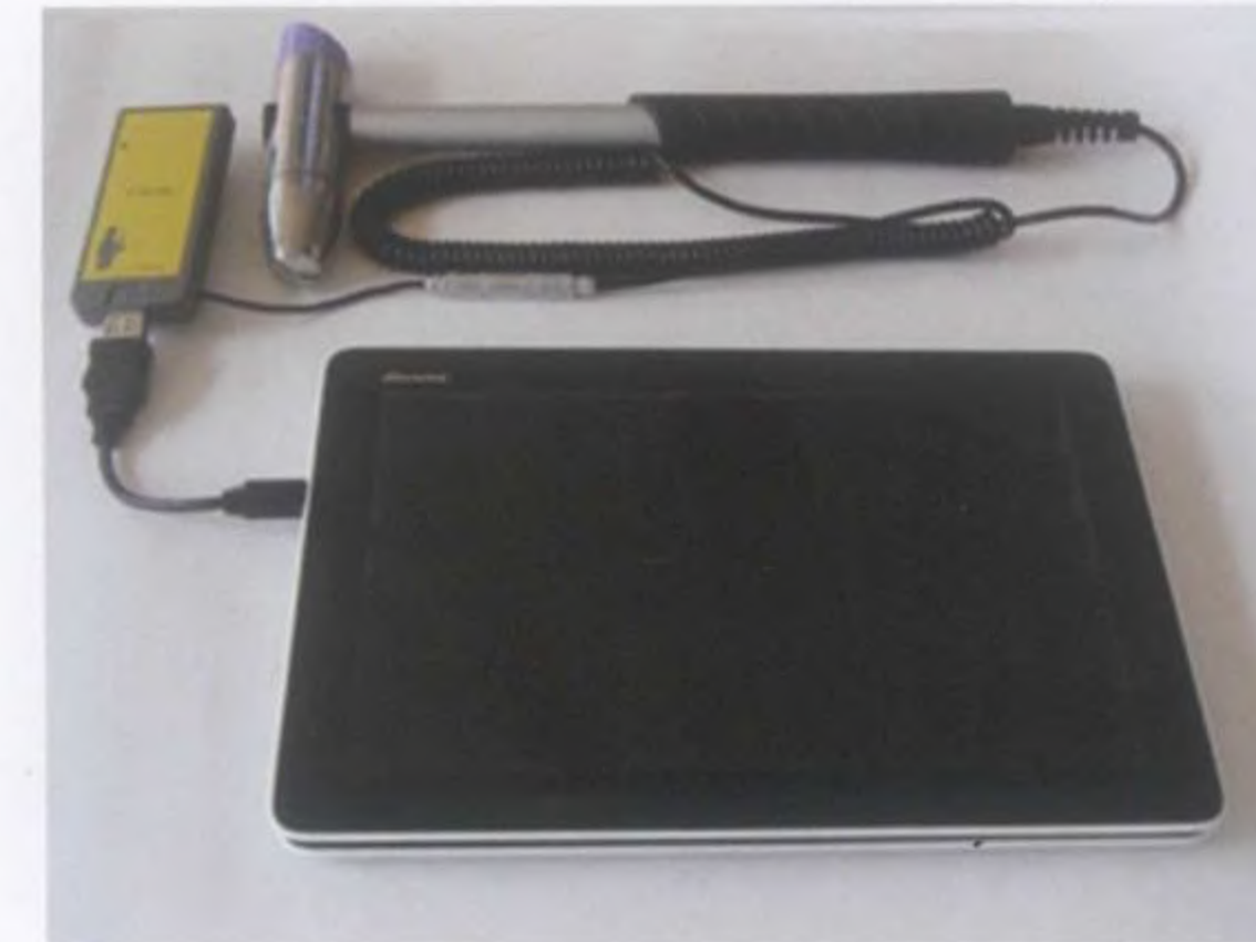
ボルトテスター(BTS)装置/外観
