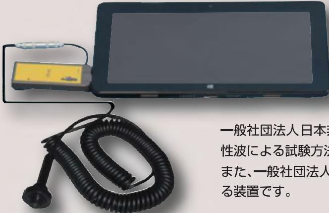
コンクリート聴診器 **iTECS-9**は、CTS-03Device用のセンサー及びアプリケーションです。基本的な機能は、**iTECS**シリーズと同様、衝撃弾性波法によるコンクリート構造物の健全性診断に使用する装置です。
